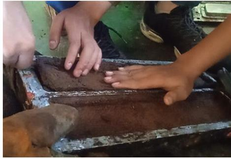
*Gambar 8. Pelepasan sampel papan komposit dari cetakan*
