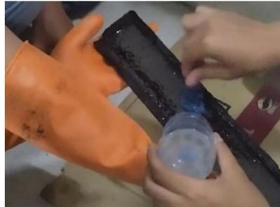
*Gambar 9. Pengolesan campuran resin katalis pada sampel papan komposit*
