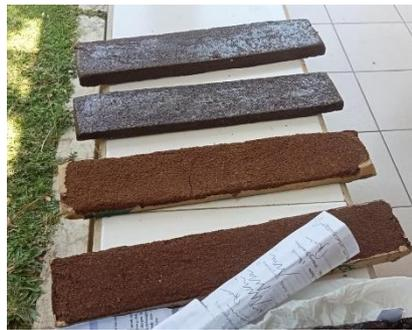
*Gambar 10. Empat sampel papan komposit yang sudah kering dan mengeras*
